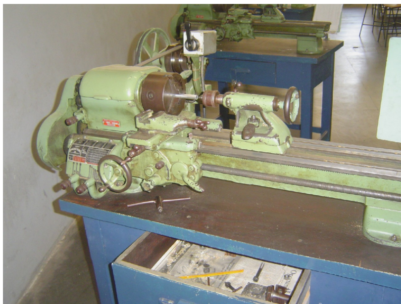
Figura 37 - Exemplo de torno mecânico usado na fabricação
