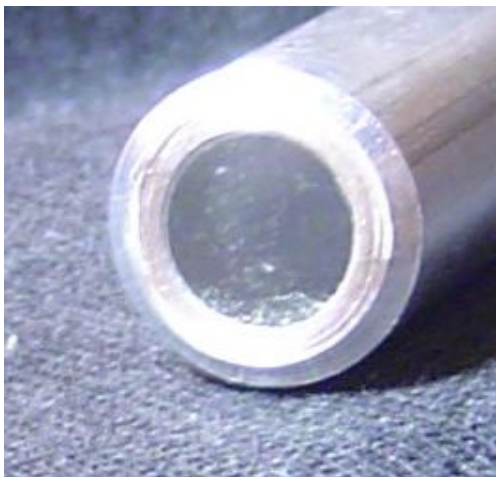
Figura 35 - Superfície cortada na serra, e acabada no torno
