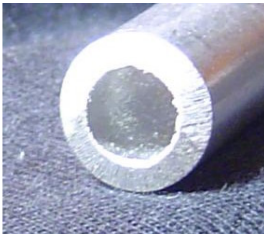
Figura 33 - Superfície após corte com serra, e acabamento com esmeril
